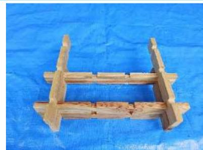
5 4の上に交差して乗る横方向の2本を、切り欠き部分を上下で合わせて置き、はめ込みます。
