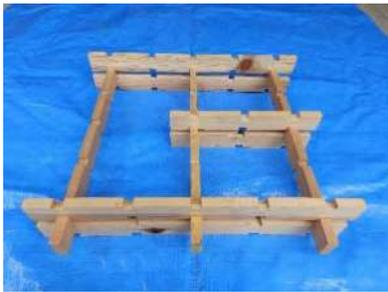
4 3の上に交差して乗る縦方向の3本を、切り欠き部分を上下で合わせて置き、はめ込みます。
