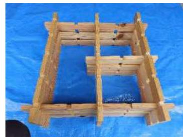
7 6の上に交差して乗る横方向の3本を、切り欠き部分を上下で合わせて置き、はめ込みます。
