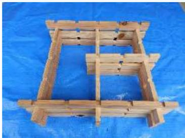
6 5の上に交差して乗る縦方向の3本を、切り欠き部分を上下で合わせて置き、はめ込みます。
