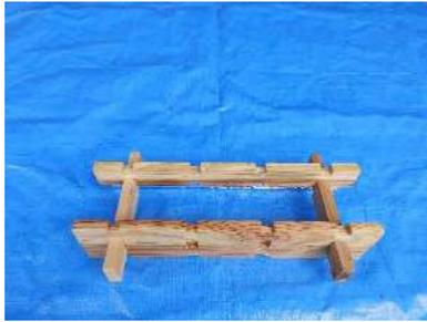
4 3の上に交差して乗る縦方向の2本を、切り欠き部分を上下で合わせて置き、はめ込みます。
