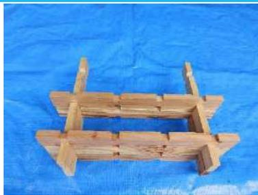
6 5の上に交差して乗る縦方向の2本を、切り欠き部分を上下で合わせて置き、はめ込みます。
