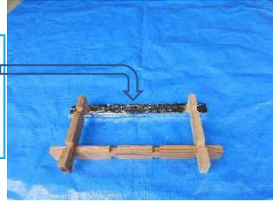
3 2の上に交差して乗る横方向の2本を、切り欠き部分を上下で合わせて置き、はめ込みます。
