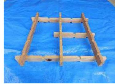
3 2の上に交差して乗る横方向の3本を、切り欠き部分を上下で合わせて置き、はめ込みます。
